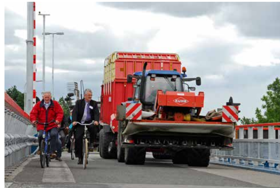
Markeringsborden zijn verplicht op verwisselbare uitrustingsstukken die meer dan 10 cm buiten de zijkant van de trekker uitsteken.
