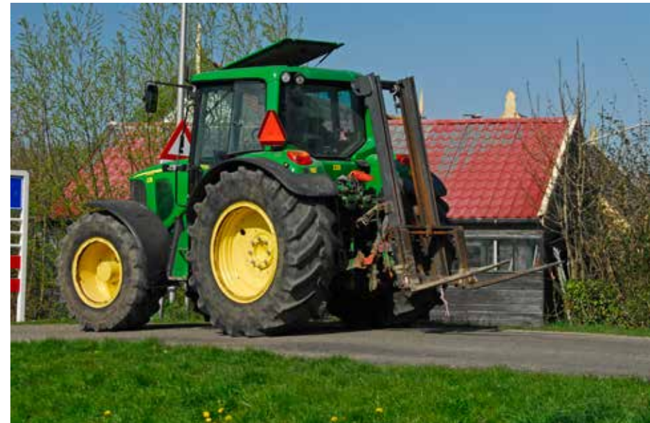
Uitstekende delen die gevaar voor andere weggebruikers opleveren moeten zijn afgeschermd.
